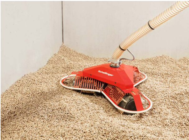
Lagerraum mit Zuführung zum Pelletkessel durch Maulwurf-System
